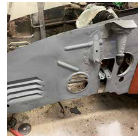
Vänster motorrum lagat
